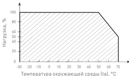
Рис. 2. Максимальная допустимая нагрузка, % от мощности источника.
