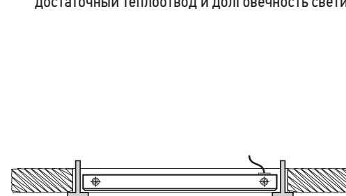
Рис. 1 Схема встраиваемого монтажа светильника PPL 595/U Opal
